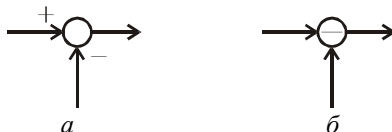
Рис. 3.26. Условное изображение сумматора на структурной схеме
